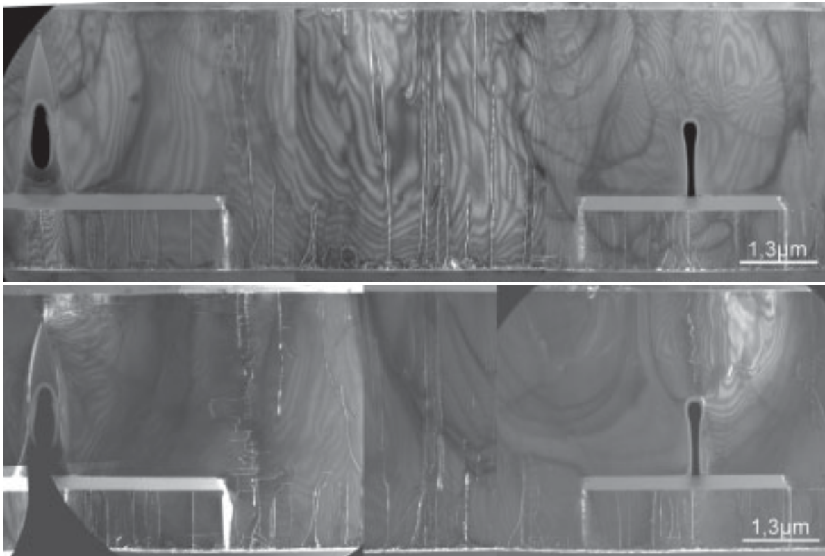
Abbildung 4.4: TEM-Dunkelfeldaufnahmen der Bruchkante einer ELO-Probe. Oben sind Versetzungen mit Schraubenkomponente, unten mit Stufenkomponente sichtbar. Die Aufnahmen wurden von K. Engl an der Universität Regensburg durchgeführt [81].
