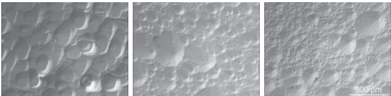
Abbildung 5.12: Oberflächenmorphologie bei einem Reaktordruck von 200 mbar, 500 mbar und 900 mbar (von links nach rechts).
