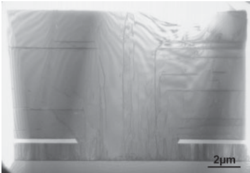
Abbildung 2.15: TEM-Hellfeld-Aufnahme eines Querschnittspräparates. Die Versetzungen sind als dunkle Linien sichtbar. Die Aufnahme wurde von K. Engl an der Universität Regensburg angefertigt [81].
