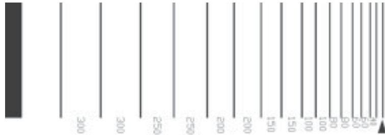
Abbildung 3.25: Maskenbereich mit weiten Abständen zwischen den je 8\ \mu\text{m} breiten Fenstern.
