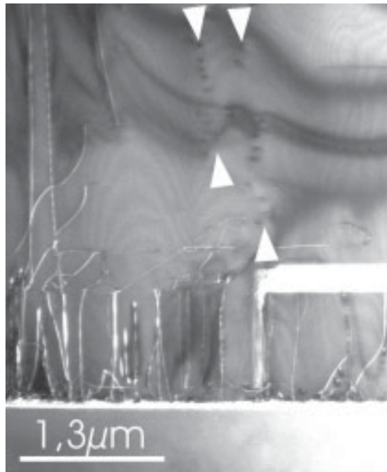
Abbildung 4.5: Die dunklen Punkte entsprechen Durchstoßpunkten von Stufenversetzungen, die in der Wachstumsebene parallel zur Maskenkante verlaufen. Diese stellen die Kleinwinkelkorngrenze zwischen Post-Bereich und geneigtem Wing-Bereich dar [81].
