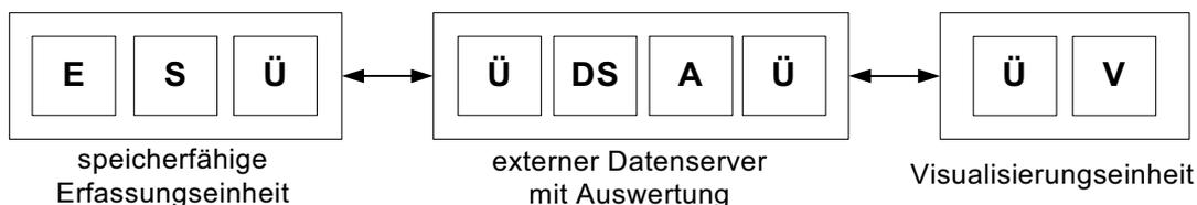
Bild A.6: Topologievariante TP5, zentral geführtes Energie-Monitoring mit Auswertung und Datenhaltung auf einem externen System
