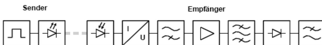
Bild 4.3: Blockschaltbild des optischen Sensors, Signalflussplan
