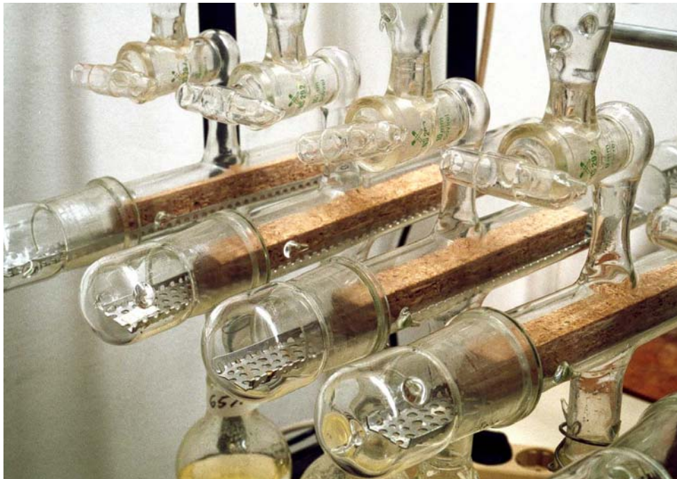
Abb. 3.3: mehrere Spanplatten-Probekörper in den evakuierten Proberäumen der Vakuumsorptionsapparatur. Am unteren Rand sind die Behälter mit den gesättigten Salzlösungen zur Erzeugung der jeweiligen relativen Luftfeuchte zu erkennen
