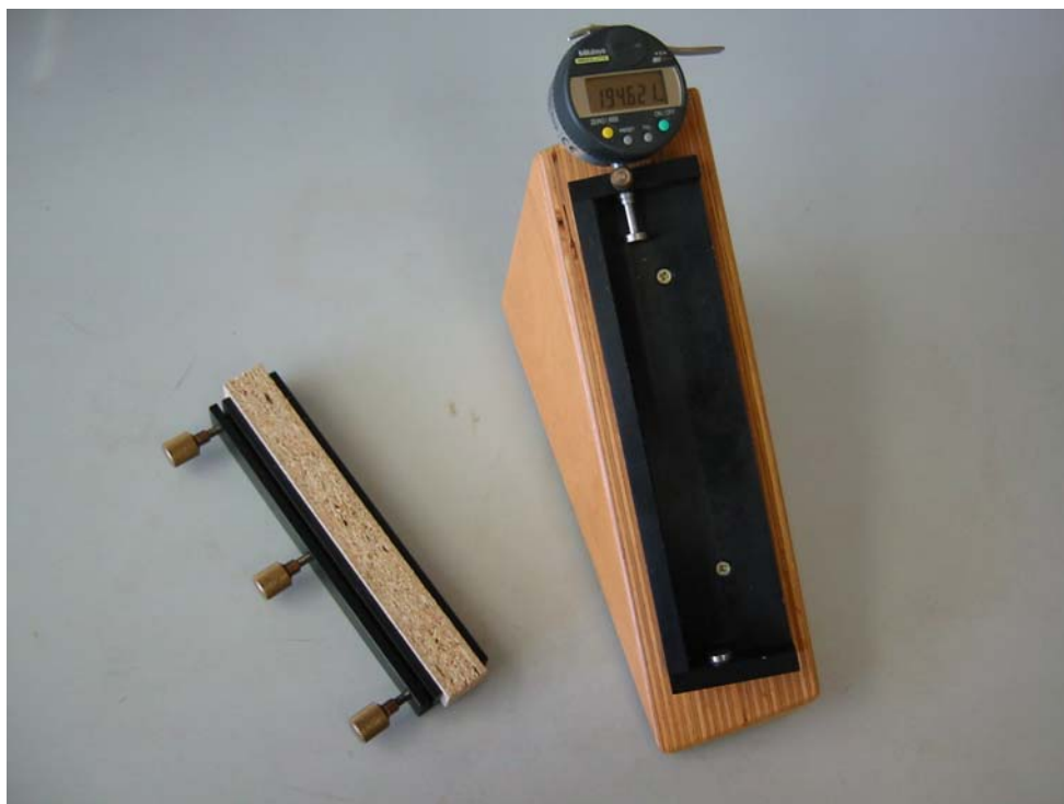
Abb. 3.4: Messgerät zur Bestimmung der Längenänderung gemäß der EN 318. Das Gerät besteht aus einem U-förmigen Rahmen, der den Probekörper aufnimmt (links im Bild) und dem eigentlichen Messgerät, in das der Rahmen mit dem Probekörper eingelegt wird
