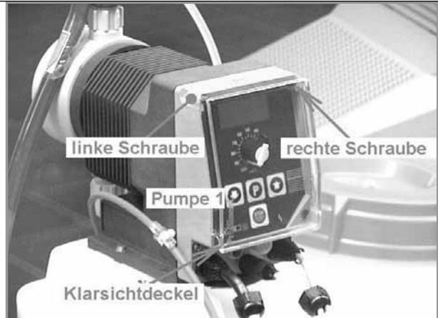
An der Pumpe 1 den Klarsichtdeckel öffnen und die beiden oberen Kreuzschlitzschrauben entfernen
