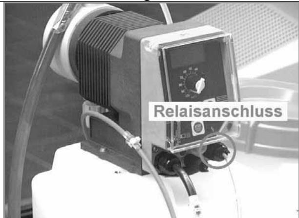
Überwurfmutter der Kabelzugentlastung
