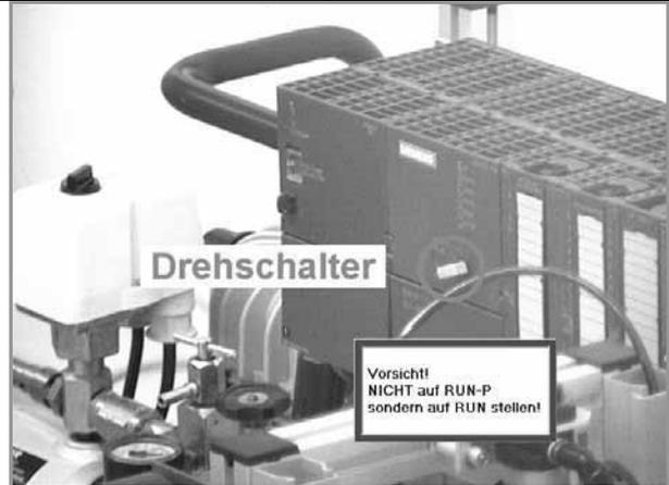
SPS-L: Auf dem Modul CPU314 den Drehschalter auf RUN stellen
