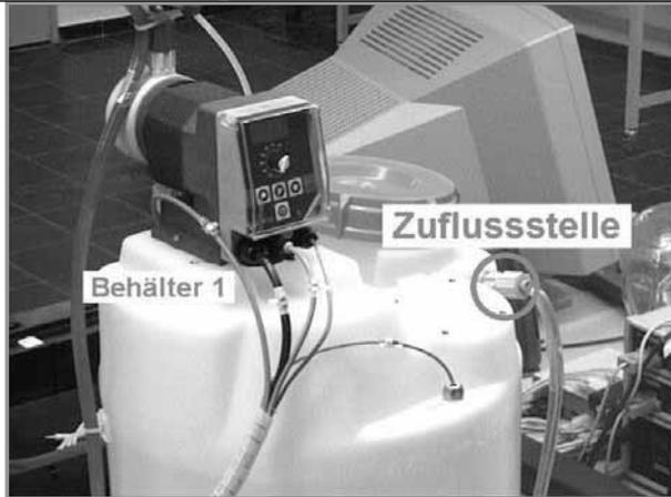
Am Behälter 1 überprüfen ob die Schlauchverbindung "V4->B1" an der Zuflussstelle besteht
