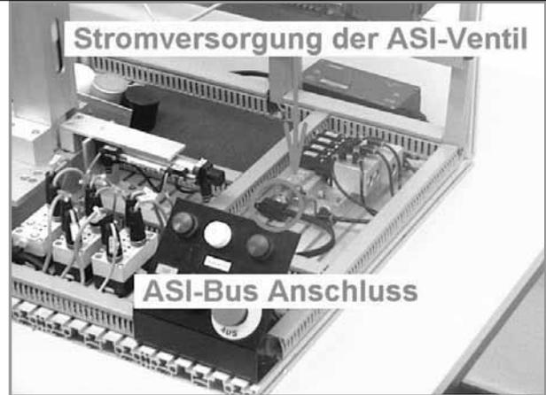
Überprüfen ob ASI-Bus Anschluss an der Stromversorgung der ASI-Ventilinsel gekoppelt ist
