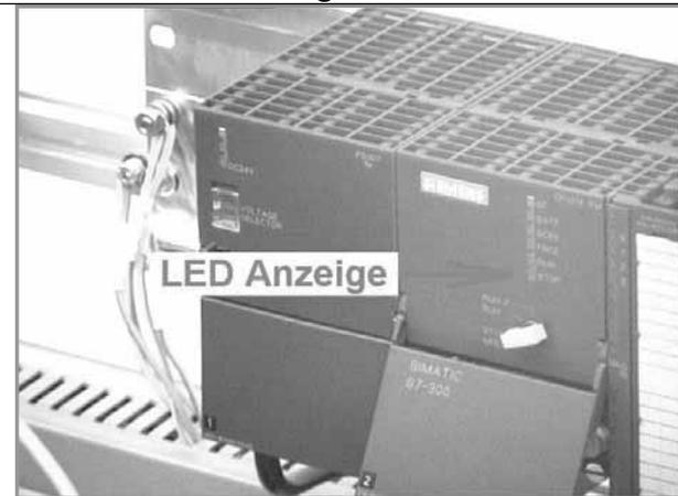
SPS-R: Überprüfen ob auf der LED Anzeige auf dem Modul CPU314, STOP dauerhaft leuchtet
