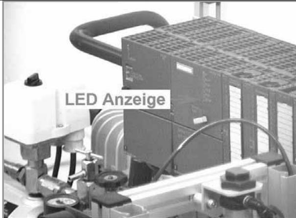
SPS-L: Überprüfen ob auf der LED Anzeige auf dem Modul CPU314, STOP dauerhaft leuchtet
