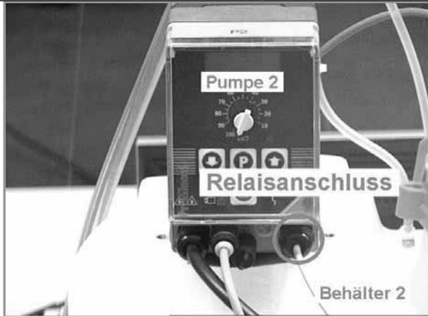
Am Behälter 2 überprüfen ob das Kabel ALR2 am Relaisanschluss der Pumpe 2 angeschlossen ist
