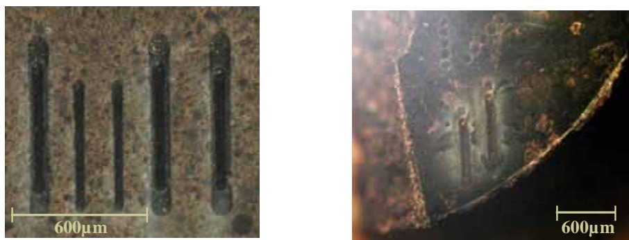
Abbildung 74: Lichtmikroskopische Abbildung der Presslinge von \text{Ca}_2\text{N} (links) und \text{Ca}_3\text{N}_2 (rechts) nach Laserablation.
