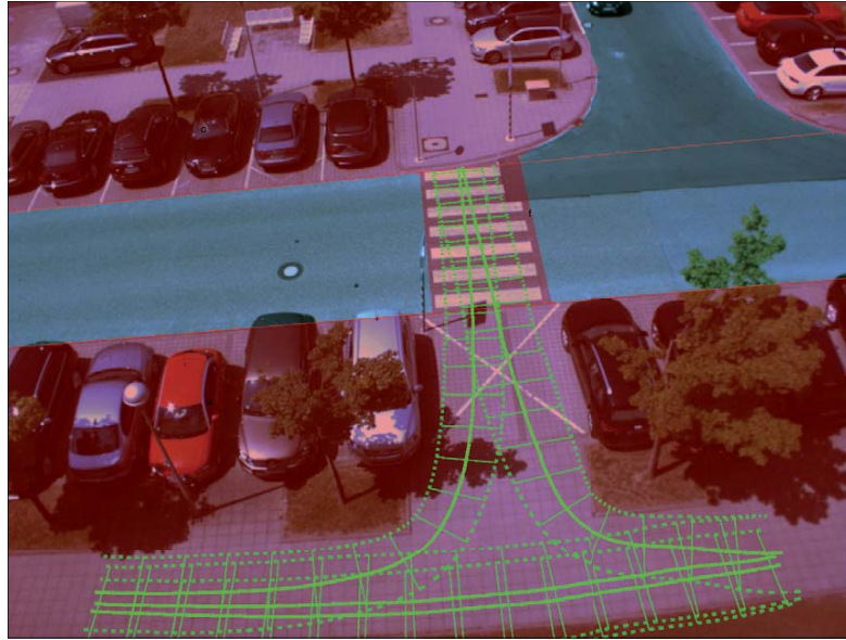
Abbildung 6.20.: Charakteristische Segmente projiziert mit gestricheltem örtlichen 2\sigma -Unsicherheitsbereich
