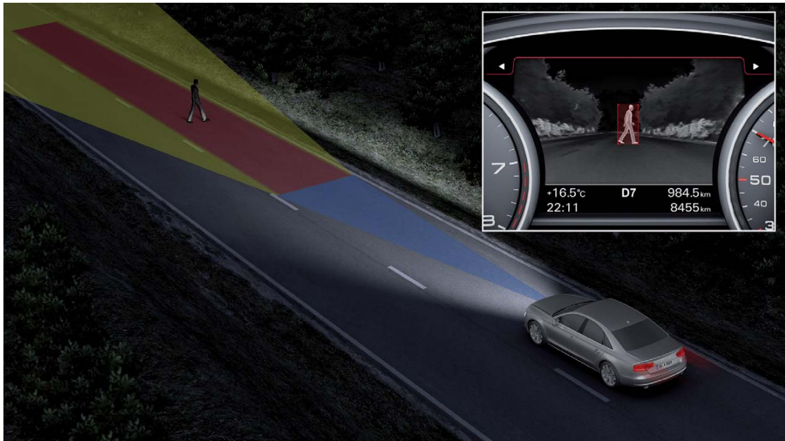
Abbildung 2.7.: Schematische Erklärung der Funktionsweise des Nachtsichtassistenten mit Markierung erkannter Fußgänger im Audi A8 1
