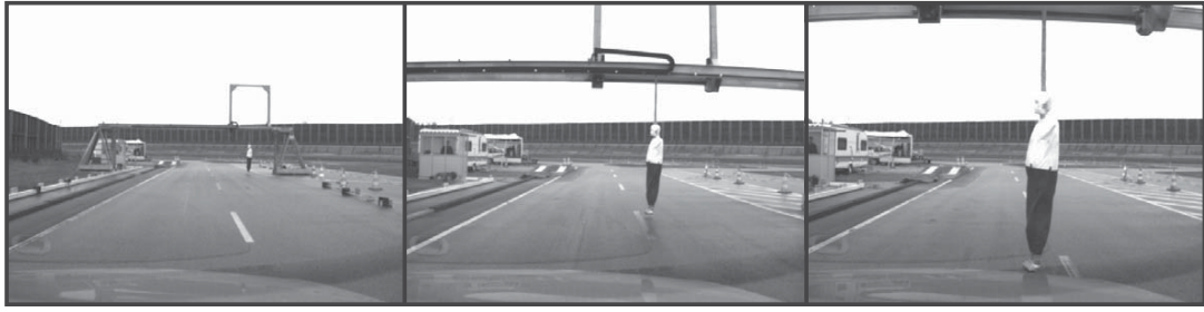
Abbildung 9.2.: Bilderserie der Fahrzeugkamera während einer Anfahrt auf die Testanlage für Pkw-Fußgänger-Kollisionen
