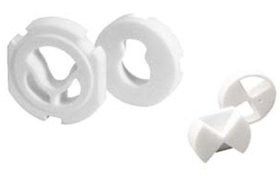
Bild 4.9: Versuchswerkstück: Dichtscheiben aus 96 %igem Aluminiumoxid
