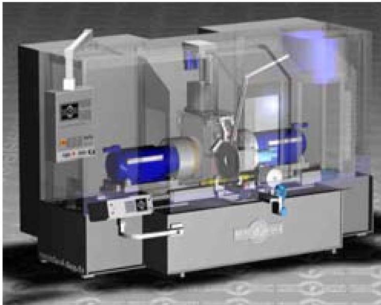
Bild 2.7: Diskusschleifmaschine mit horizontaler Lage der Werkzeugspindeln [Dis03]
