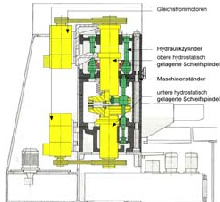
Bild 4.2: Maschinenprinzip WBM 200 [Wen95]
