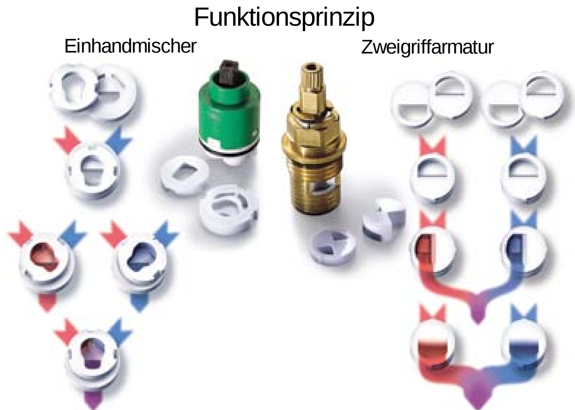
Bild 4.10: Funktionsprinzip der Einhandmischer und Zweigriffarmaturen
