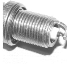
**Bild 3.14:** Zündkerze mit nach vorne verjüngter Elektrode
