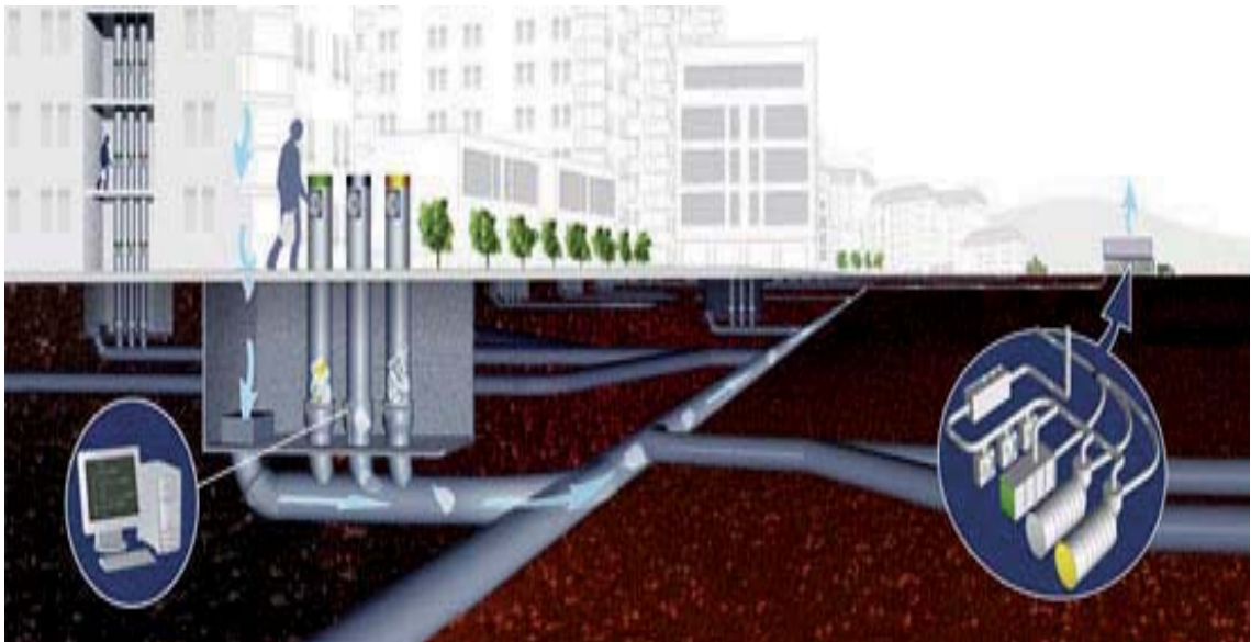
Abbildung 75: Unterirdische Absauganlage für Abfall
