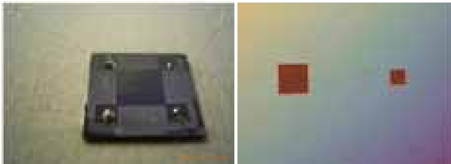
Abbildung 8.5: Links: Eine Kleeblattprobe nach lithographischer Strukturierung und Kontaktierung. Rechts: Untersuchung der Probe auf Indium-Tröpfchen nach der Eindiffusion der Indiumkontakte [131].
