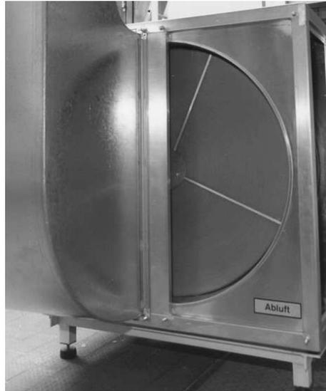
**Abbildung 3.4:** Sorptionsrotor (Versuchsanlage der TUHH)
