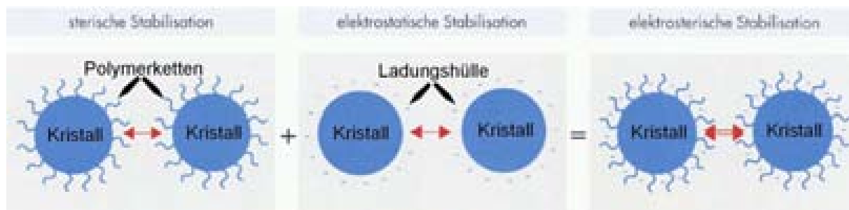
Bild 2.11 Schematische Darstellung der Stabilisierung bei Einsatz von Polyasparaginsäure nach [54]
