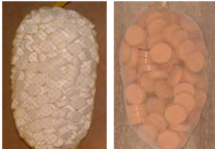
Bild 2.15 Depotsteine Polyacrylat, Polysuccinimid
