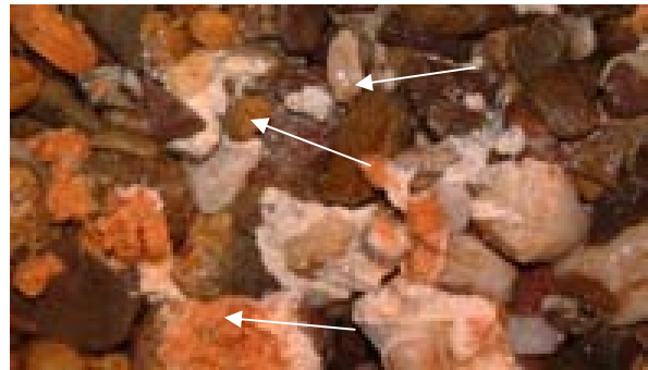
Bild 5.23 Calciumstearatbildung in der Filterschicht (Phase B)
