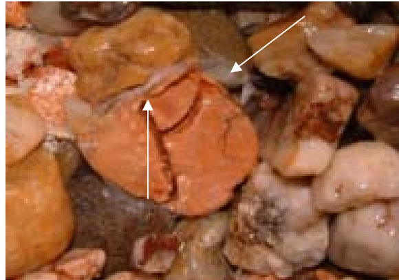
Bild 5.21 Schimmelbildung an den Depotsteinen (Phase B)
