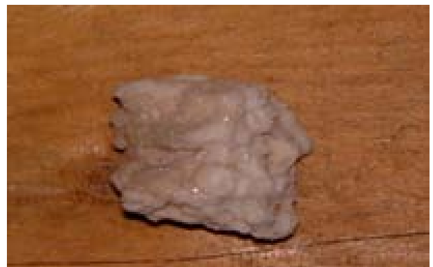
Bild 5.19 Harte Ablagerung aus der konditionierten Wanne in Phase A
