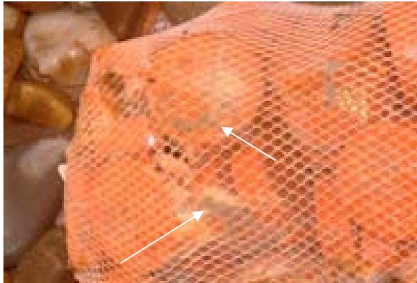
Bild 5.20 Schimmelbildung an den Depotsteinen (Phase A)
