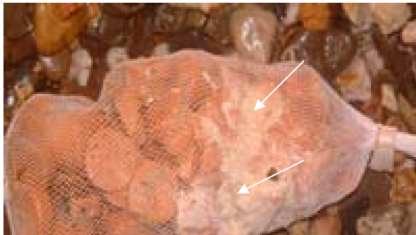
Bild 5.22 Depotsteine mit Ablagerungen von Calciumstearat (Phase A)
