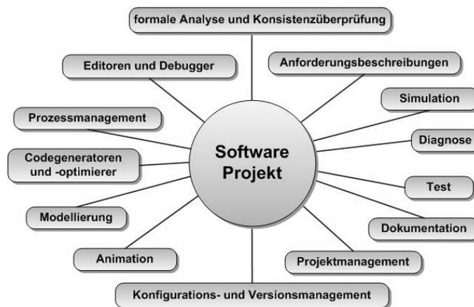
Abbildung 2-8: Mögliche Aufgaben in einem modellbasierten SW-Entwicklungsprozess
