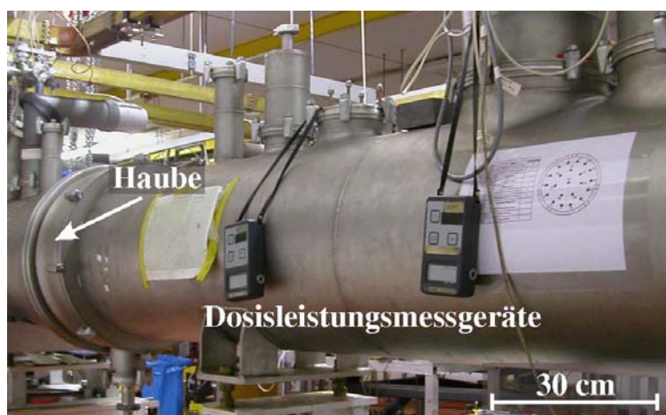
Abb. 4.5: Experimenteller Aufbau zur Dosisleistungsmessung.
