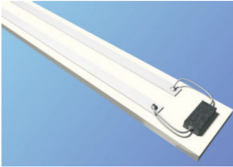
Abbildung 8.7: Prinzipskizze des Probenträgers zum Nachweis elektrischen Stroms. Der Kristall befindet sich auf einer länglichen, 3mm schmalen Platine, auf der die Zuleitungen durch Kupferleiterbahnen starr realisiert sind. Die eigentliche Kontaktierung erfolgt über 25 \mu m Golddrähtchen, die mit Graphitpaste an die Stirnflächen des Kristall angeklebt wurden.
