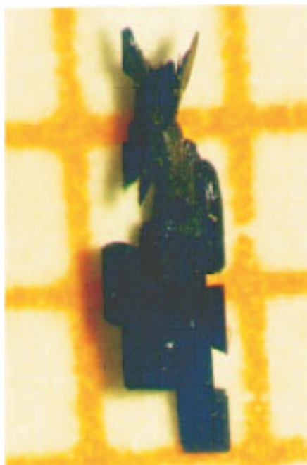
Abbildung 4.2: Mikroskopische Photographie eines (Pyrene) 12 (SbF 6 ) 7 -Kristalls auf einem Millimeterraster. Im oberen Bereich ist die Negativform der Stabanode an der Kristallform zu erkennen.
