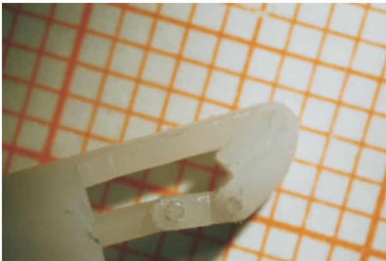
Abbildung 3.5: Goniometer zur Rotation um beliebige Achsen, einsetzbar im Resonator mit Innendurchmesser von 4mm im Temperaturbereich von 4-300K. Den Hintergrund bildet ein Millimeterraster.
