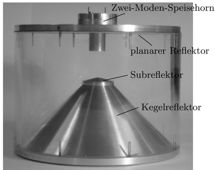
**Bild 4.42:** Omnidirektionale Antenne mit drei Reflektoren
