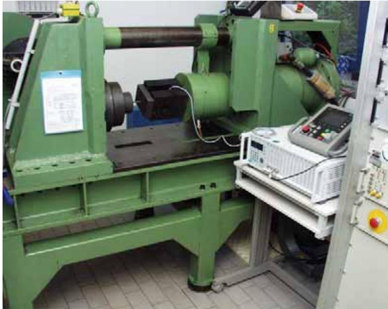
*Bild 5.27 Prüfstand zur Bestimmung Federsteifigkeit und Dämpfung einer PTFE-Gleitschicht (Gesamtaufbau)*
