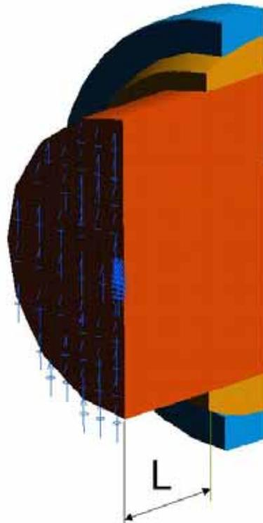
*Bild 4.7 Einleitung der Kraft an den Stirnseiten der Welle unter Ausnutzung von Symmetriebedingungen*
