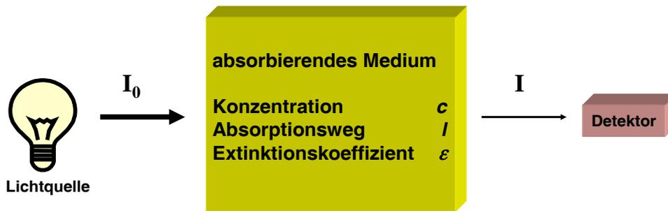
Abb. 2.3: Prinzip der klassischen Absorptionsspektroskopie.
