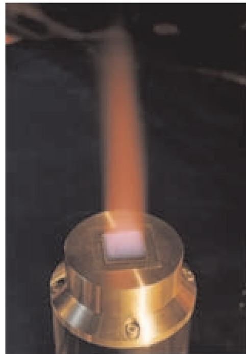
Abb. 1.2: Für die Untersuchung von Verbrennungsprozessen bedient man sich Modellbrennern wie z.B. dem hier gezeigten Hencken-Brenner.
