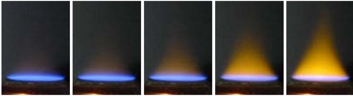
Abb. 6.2: Laminare Methan/Luft-Flamme stabilisiert an einem McKenna-Brenner mit unterschiedlichen – von links nach rechts zunehmenden – Natrium-Konzentrationen.
