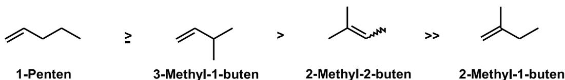
Abbildung 3.10: Reaktivitätsreihe der verwendeten C<sub>5</sub>-Olefine in der Homometathese
