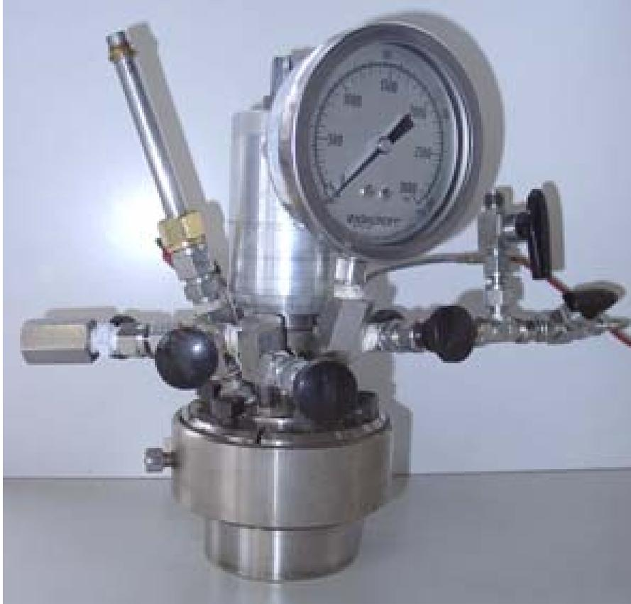
Abbildung 6.2: Foto des modifizierten PARR-Druckreaktors
