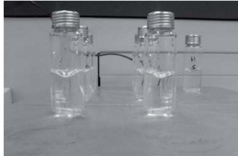
**Abbildung 2-20** Aromastoff-Isolierung mittels Stir-Bar Sorptive Extraction (SBSE)
