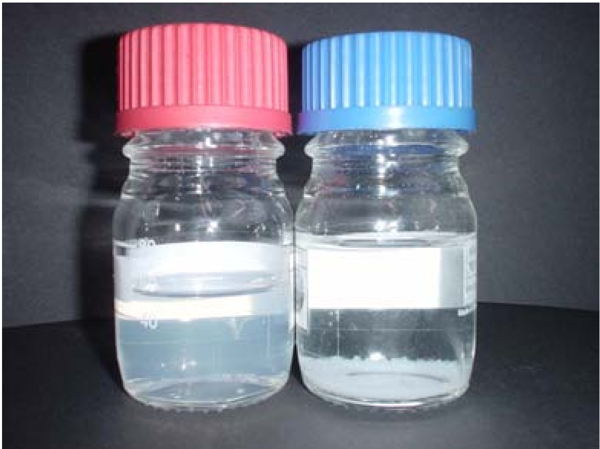
Abbildung 3-13: Vergleich einer stabilen Suspension in Ethylenglykol (links, JB99) und eines geflockten Pulvers in Wasser (rechts, JB100)
