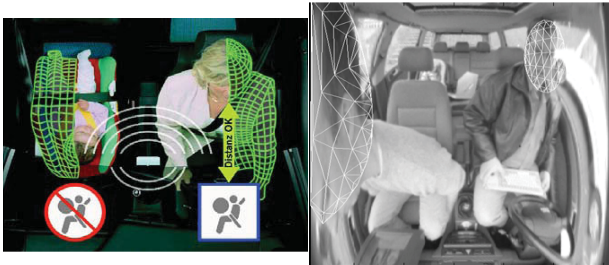
Abbildung 1.3: Im linken Bild wird die Unterscheidung zwischen Person und Kindersitz dargestellt (Personenklassifikation). Im rechten Bild wird eine Entfernungsmessung über die Position des Kopfes durchgeführt. Diese Ergebnisse wurde mit einem System der Firma Robert-Bosch erzeugt und in [A10] veröffentlicht. Bildquelle [A10]
