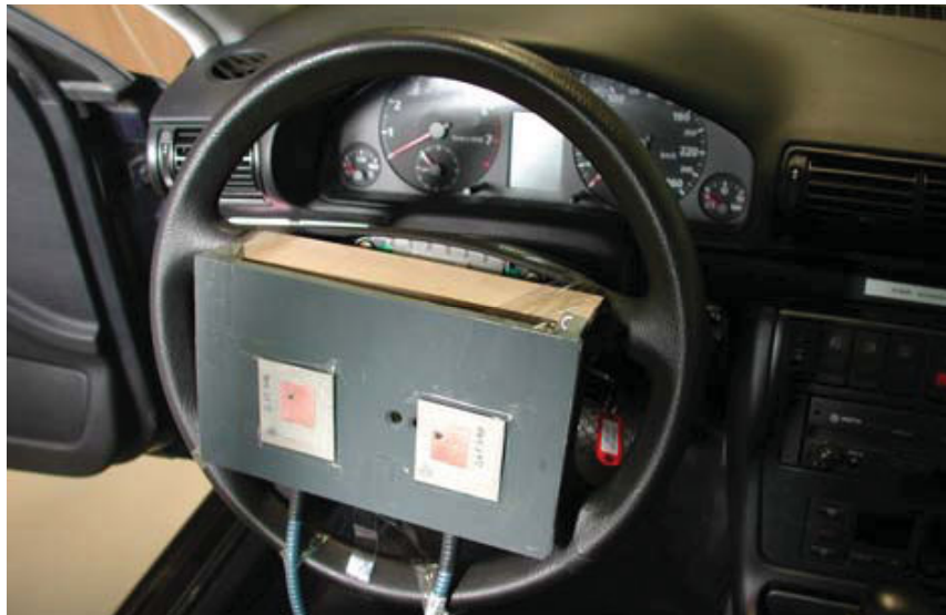
Abbildung 7.5: Sende- und Empfangsantenne auf dem Lenkrad des Versuchsfahrzeugs montiert.
