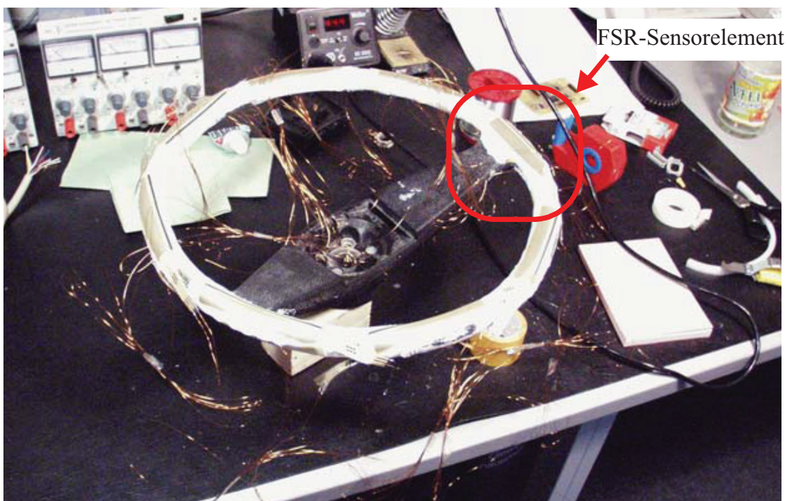
Abbildung 4.12a: Bilder des realisierten Lenkrads mit FSR-Sensorelemente. [D4]. Im Kreis ist das montierte Sensorelement zu sehen
