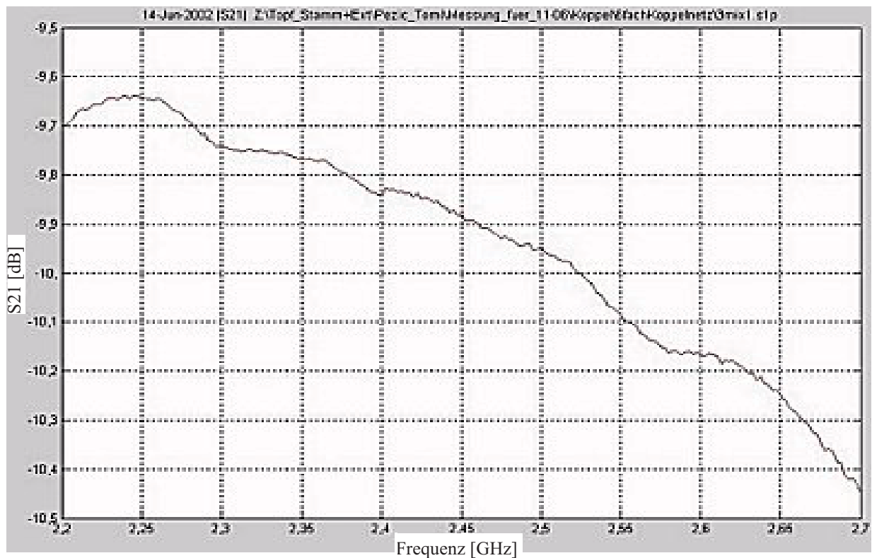
Abbildung F.29 Dämpfung- S_{21} zwischen dem Eingangstor und dem ersten Ausgangstor in dB über der Frequenz.
