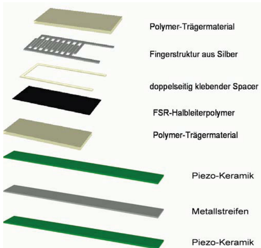
Abbildung 4.11: Schematischer Aufbau der verwendeten Drucksensorik Elemente für die Messungen am Lenkrad. Oben: FSR-Sensorelement, unten: Bimorphes-Element. Bildquelle [D5]
