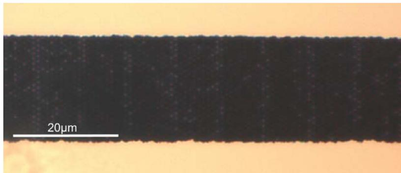
**Abbildung 6.9.:** Lichtmikroskopaufnahme einer Aussparung im Ag-Spiegel. Die Kanten zeigen eine leichte Welligkeit im Bereich weniger  $\mu\text{m}$ . Dies hätte bei einem späteren Bauteil keine Relevanz.
