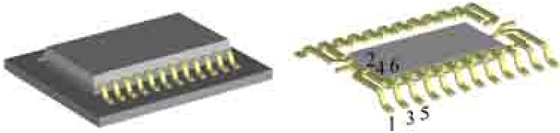
Abbildung 7.17: Das untersuchte Chipgehäuse mit 24 Zuleitungen. Links ist die simulierte Gesamtstruktur einschließlich des Substrats dargestellt, rechts die zum Teil im Inneren liegenden metallischen Zuleitungen und das Siliziumplättchen. Die Nummerierung markiert die Ports, deren Streuparameter in der folgenden Abbildung dargestellt sind.
