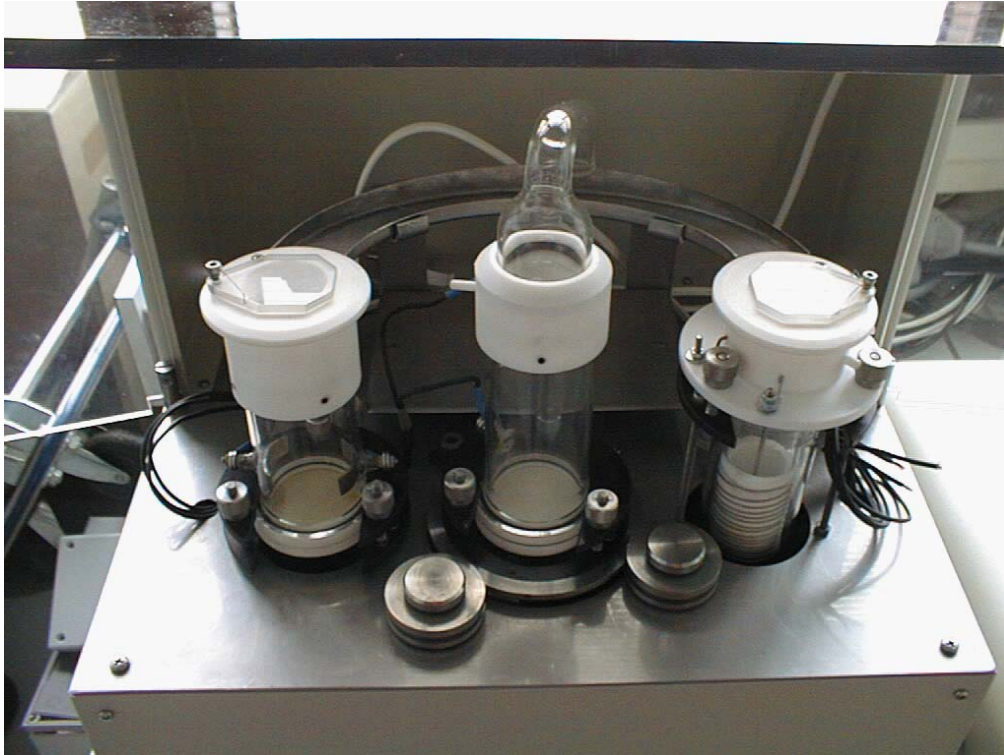
Abb. 7.7: Abbildung der FA1-Apparatur. Die mittlere Zelle ist der Schaumgenerator, in dem der Schaum über einer porösen Glasfritte durch Durchblasen von Luft hergestellt wird. Der Schaum kann dann wahlweise in die Drainage-Zelle (links) oder die Lebensdauer-Zelle (rechts) überführt werden, wo dann die Messung stattfindet.
