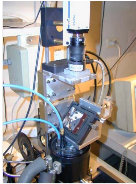
Abb. 7.15: Alter Aufbau ohne thermostatisierbare Box und mit einer undurchsichtigen Messzelle aus Hartgummi.
