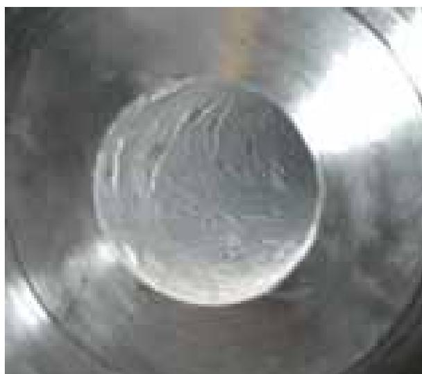
Abb. 3.11: Partikelschicht an der Rohrwand nach Förderung von Quarzmehl mit  $d_{P,50} = 3 \mu m$
