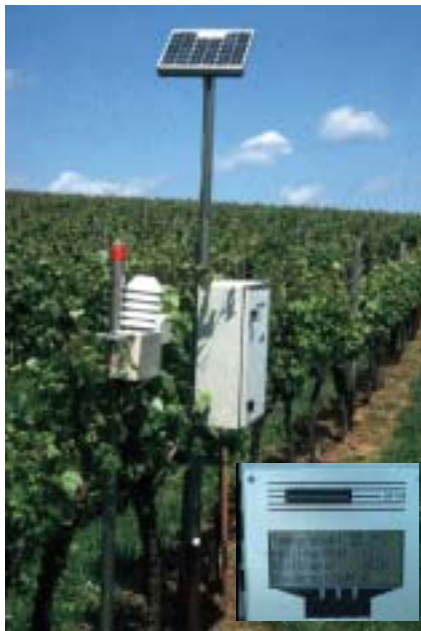
Abb. 6: Elektronische Wetterstation zur Erfassung der Klimadaten (HP 100 Fa. Lufft)
