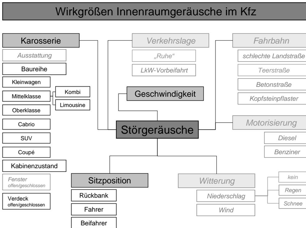
Abbildung 5.1: Darstellung der Störgeräuschsituation im Fahrzeug. Die untersuchten Wirkgrößen sind in schwarz dargestellt, die nicht berücksichtigten bzw. konstant gehaltenen sind kursiv gesetzt und grau.
