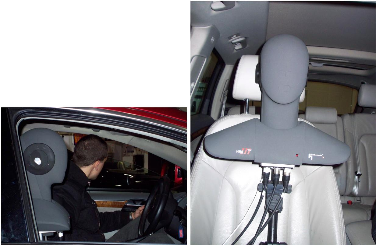
Abbildung 5.4: Versuchsaufbau für die Aufzeichnungen von Innenraumgeräuschen und Sprachwiedergabe auf dem Beifahrerplatz im Fahrzeug.
