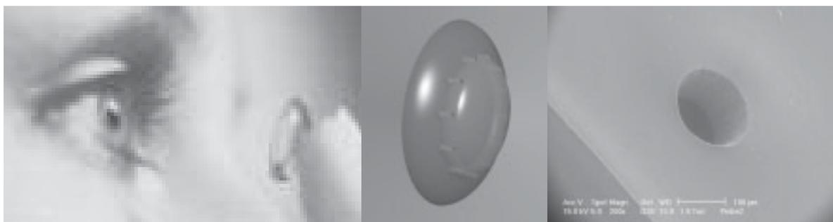
**Abbildung 2.3:** Bohrung in einer Polymerkontaktlinse (rechts) zur Erhöhung der Sauerstoffzirku- lation in der Tränenflüssigkeit. Die Bohrungen sind kreisförmig im Randbereich der Kontaktlinse angeordnet (Mitte).
