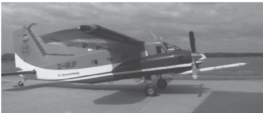
Abbildung 1.1: Forschungsflugzeug D-IBUF der Technischen Universität Braunschweig vom Typ Dornier Do 128-6. Unter dem Bug des Flugzeuges ist bereits ein Nasenmast zur Aufnahme von Sensoren angebracht.
