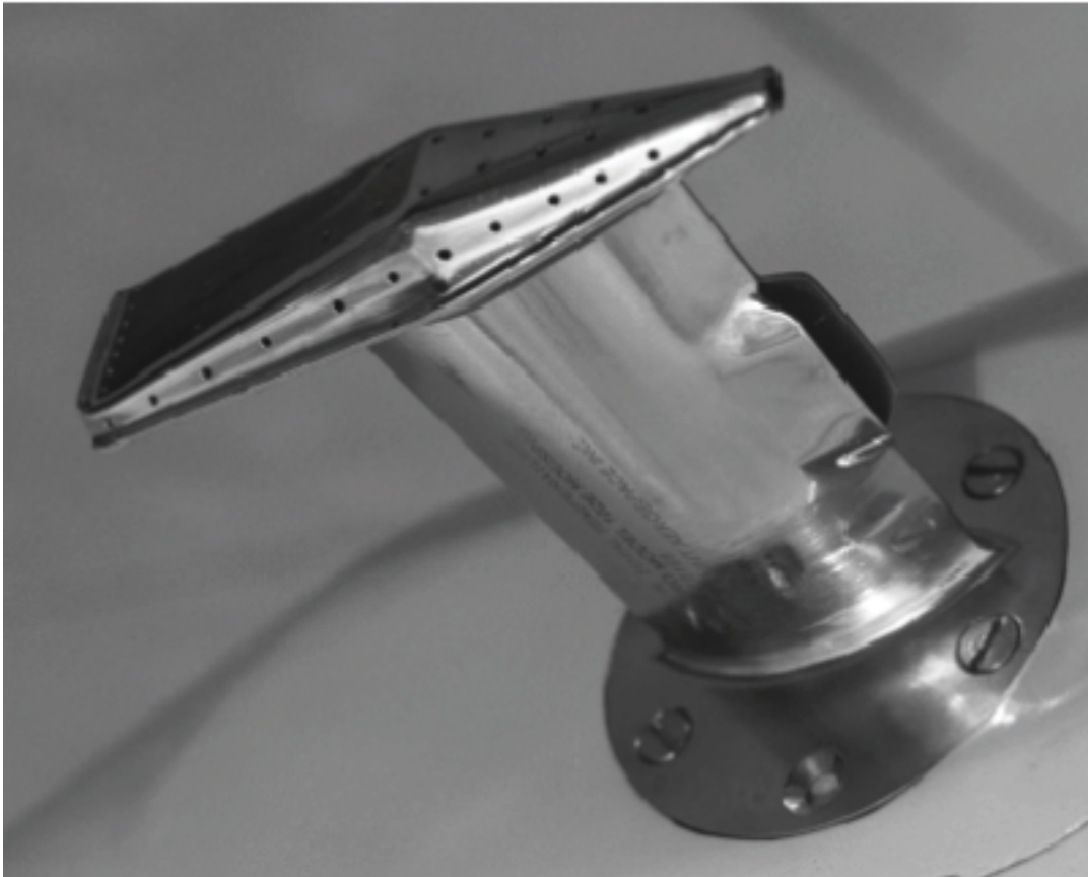
Abbildung 2.1: Kommerzieller Temperatursensor für den Einsatz an Luftfahrzeugen im sub- und transsonischen Bereich nach ROSEMOUNT auf Basis eines Widerstandselements [33]. Die Anströmung erfolgt im Bild von links nach rechts. Länge etwa 10 cm, innerer Aufbau siehe Abbildung 2.2.
