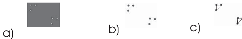
Abb. 9.6: Lokalisierung der Markerzentren: a) originales Graustufenbild, b) Binärbild, c) berechnete Schwerpunktdistanzen
