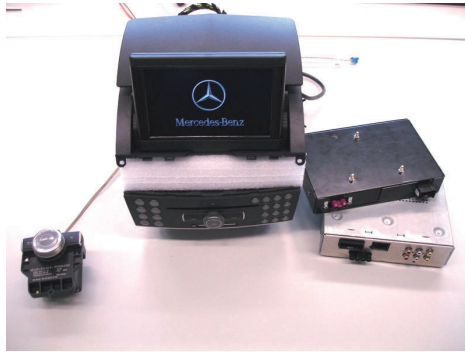
Abbildung 1: Telematiksystem bestehend aus mehreren Steuergeräten
