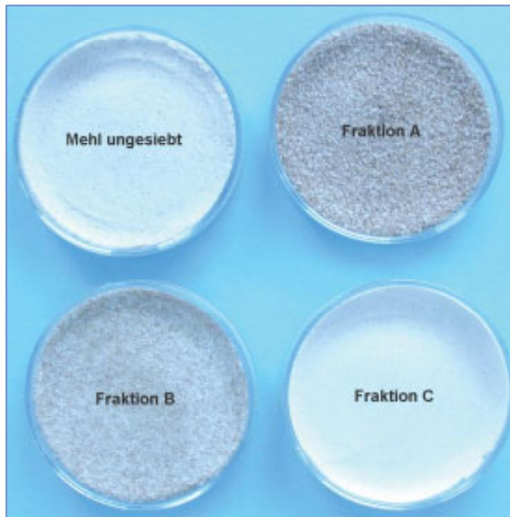
**Abb. 6:** Verschiedene Fraktionen eines Vollkornmehls nach Trennung mit Siebe unterschiedlicher Maschenweite.
