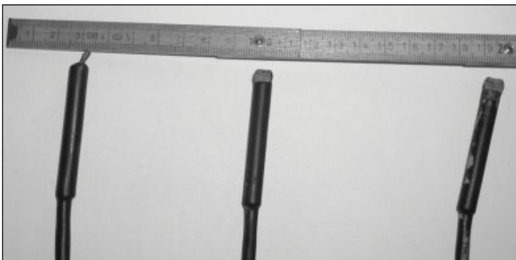
Abbildung 38: Messsonden zur Temperaturmessung
