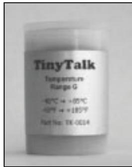
Abbildung 39: Außentemperatursensor
