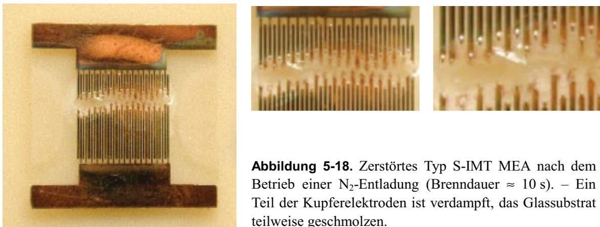
**Abbildung 5-18.** Zerstörtes Typ S-IMT MEA nach dem Betrieb einer N<sub>2</sub>-Entladung (Brenndauer ≈ 10 s). – Ein Teil der Kupferelektroden ist verdampft, das Glassubstrat teilweise geschmolzen.
