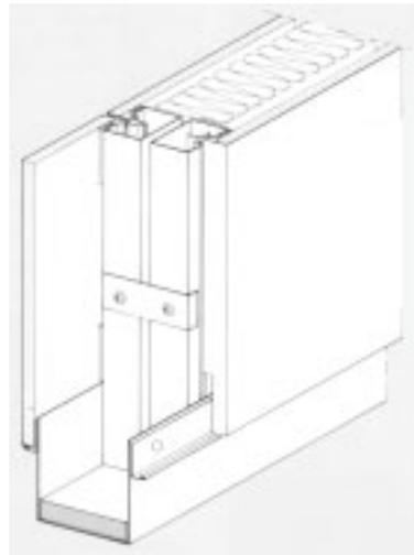
Schalenwand mit einklemmbaren Metallschalen
