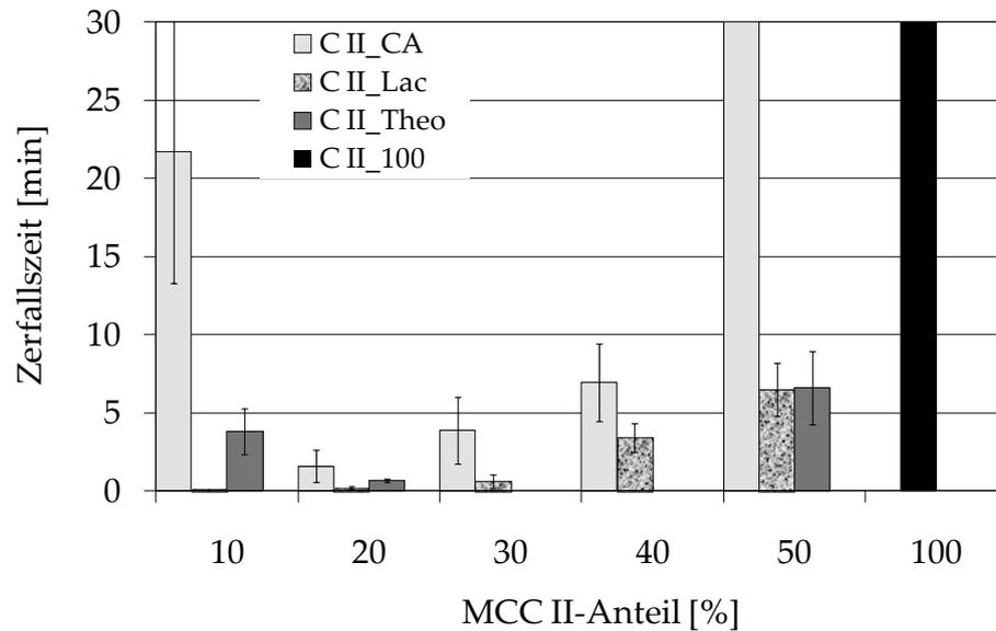
Abbildung 15: Ergebnisse des Zerfallstest nach Ph. Eur. modifiziert nach Kleinebudde (n = 6, MW ± s)
