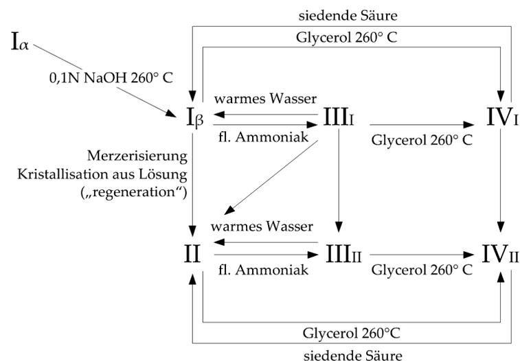
Abbildung 2: Polymorphie der Cellulose nach Kroon-Batenburg et al. [1996]
