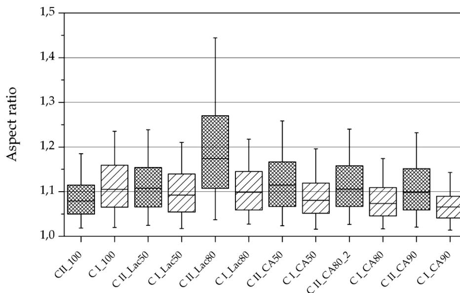
Abbildung 22: Pelletform aller untersuchen Pelletformulierungen (n = 500,  $\chi_5$ ,  $\chi_{25}$ ,  $\chi_{50}$ ,  $\chi_{75}$ ,  $\chi_{95}$ )
