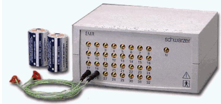
**Abbildung 31: Vorverstärker für die EEG Ableitung**
