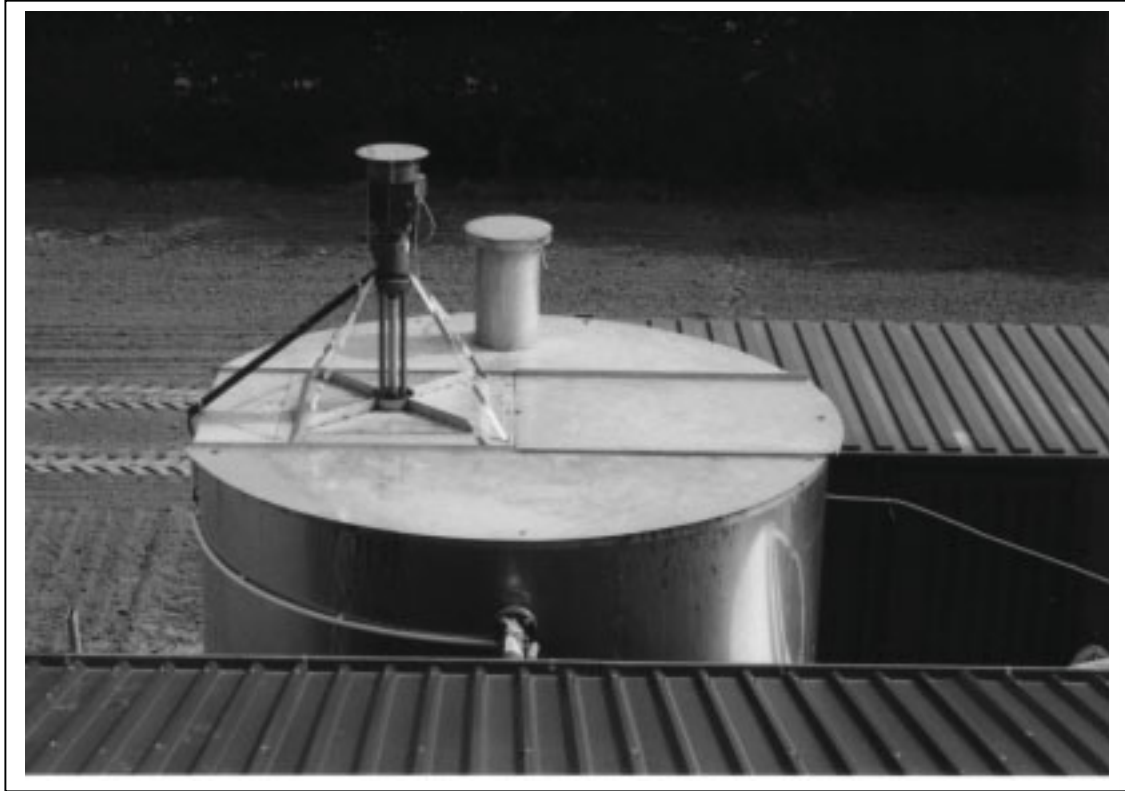
Abb. A.10: Bioreaktor: Deckelteilung, Rührwerksmotor, Abluftschacht
