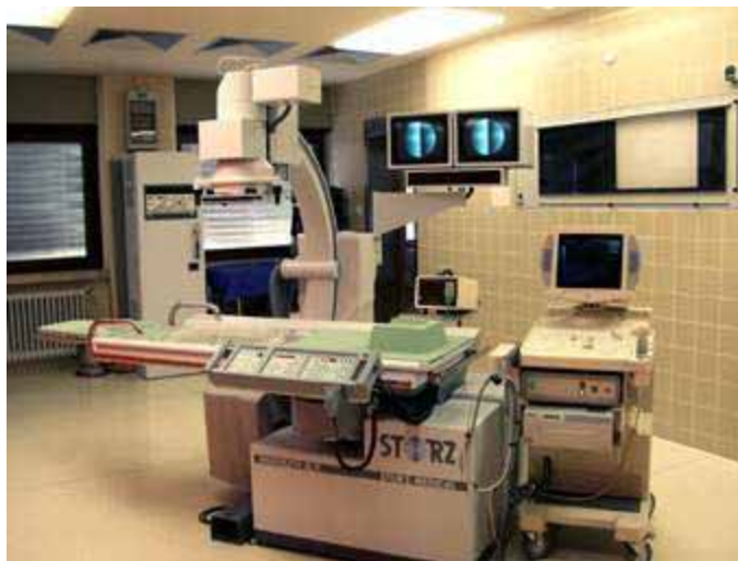
Modolith® – Lithotriktor mit Ultraschall und Röntgenortung
