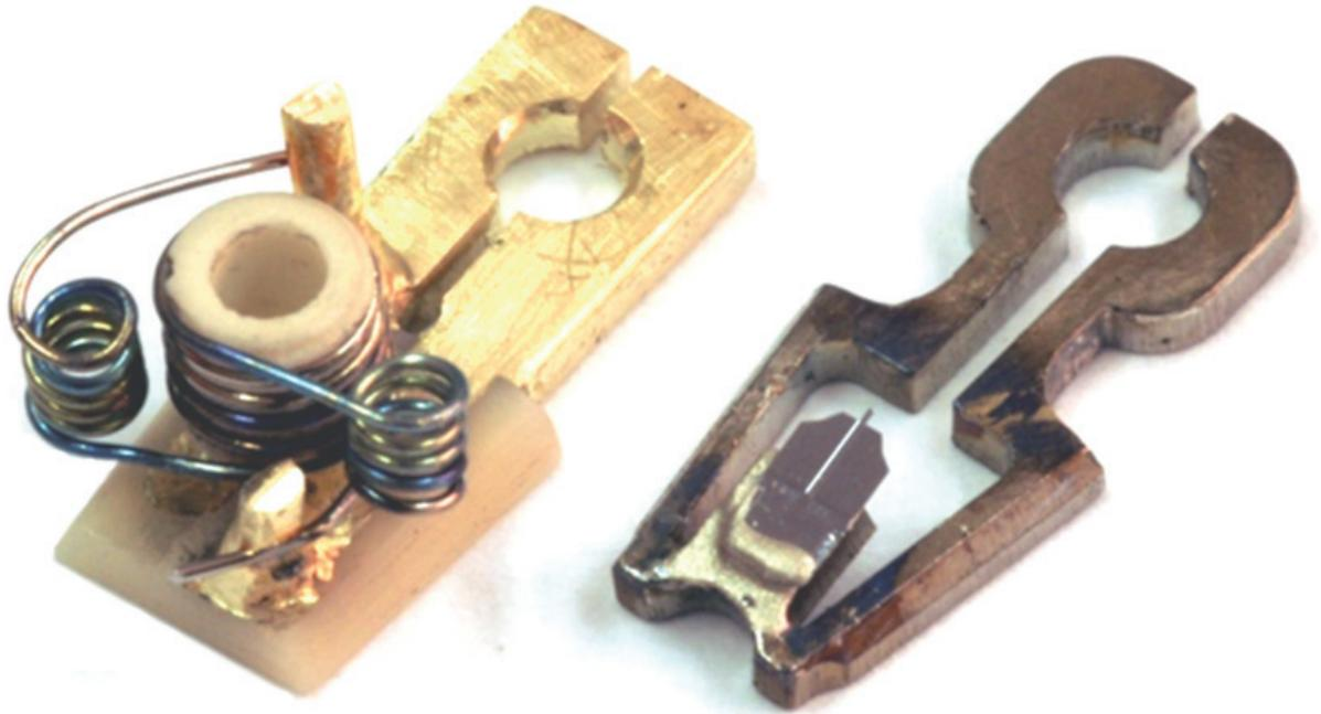
**Abbildung 3.7:** a) Foto eines fertig aufgebauten Verdampfers bestehend aus Tiegel, Heizwendel und Grundplatte. Um den Weg zwischen Tiegel und Grundplatte zu verlängern ist die Heizwendel seitlich vom Tiegel abermals zu Wendeln geformt. Die Heizwendel wurde durch Punktschweißen an den Stiften der Grundplatte befestigt. b) Kraftsensor auf einem Kraftsensorhalter. Die Gesamtlänge der Grundplatte sowie des Kraftsensorhalters beträgt 12 mm.
