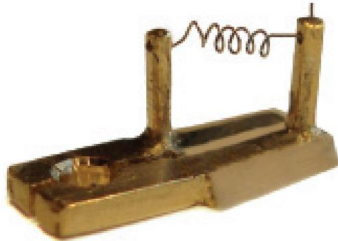
**Abbildung 3.12:** Photographie eines Verdampfers, der anstelle eines Tiegels einen aus einer Halogenlampe entnommenen Wolframdraht heizt. Durch ein Beschichten des Drahts mit einem nicht mit Wolfram legierenden Metall kann so ein Verdampfer aufgebaut werden, der dazu geeignet ist einzelne Atome auf einer gekühlten Probe zu deponieren.
