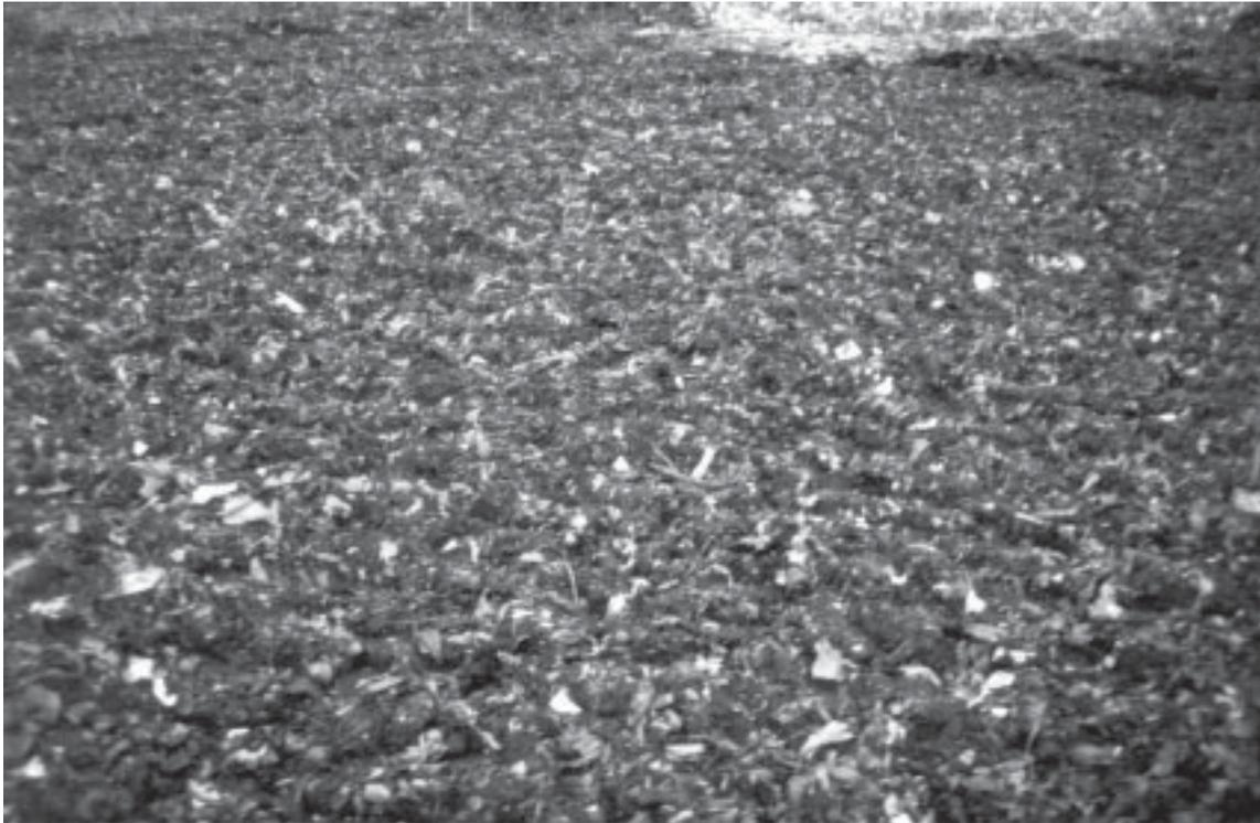
Foto 4: Oberfläche des Versuchsfeldes 4 nach dem Einbau mit der Schaffußwalze
