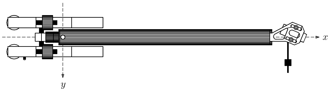
Bild 79: Ansicht des Tonarms in z -Richtung zur Begründung des zusätzlichen Gegengewichts am Headshell unter der Forderung \Theta_{12} = 0
