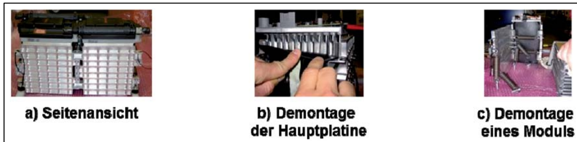
Abbildung B-2: Eindrücke der Testdemontage des Batteriesystems B,
