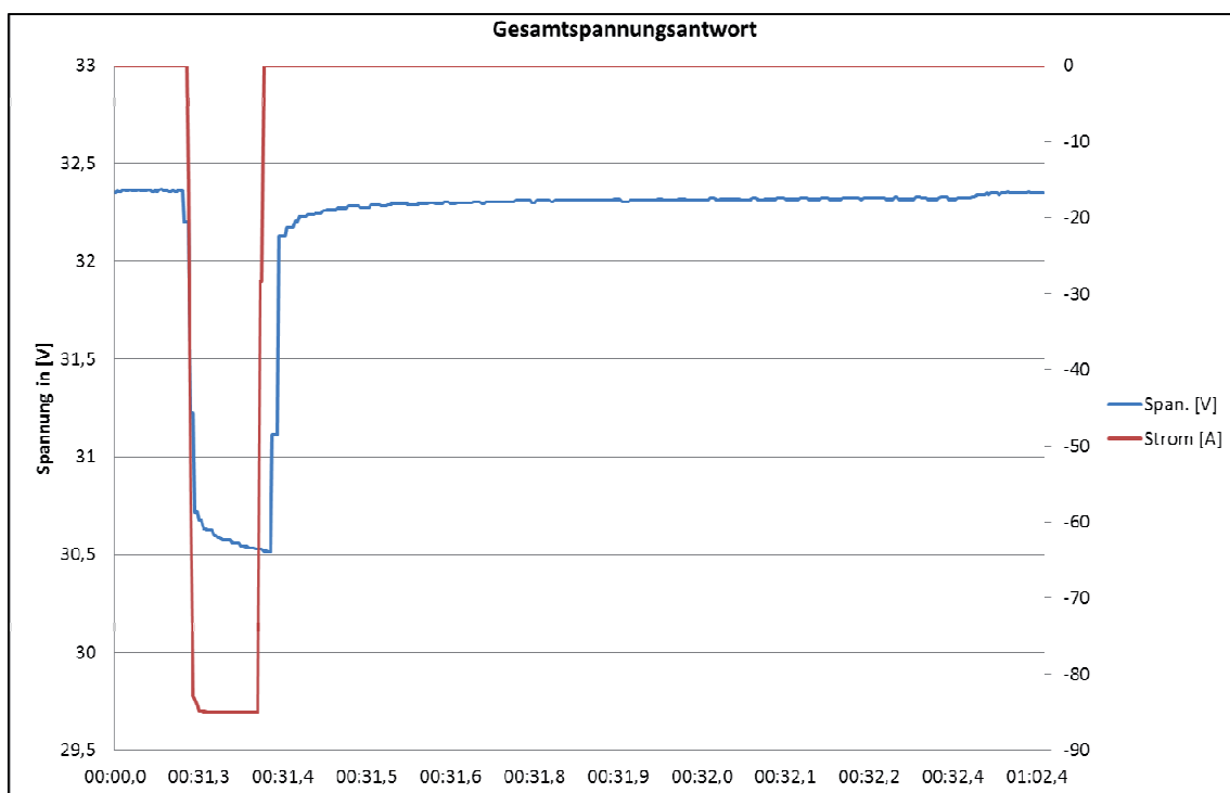
Abbildung D-7: Sprungantwort der Gesamtspannung des Systems
