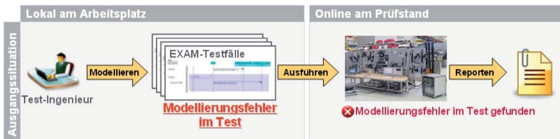
Abbildung 3.1: Fehler bei der Testausführung
