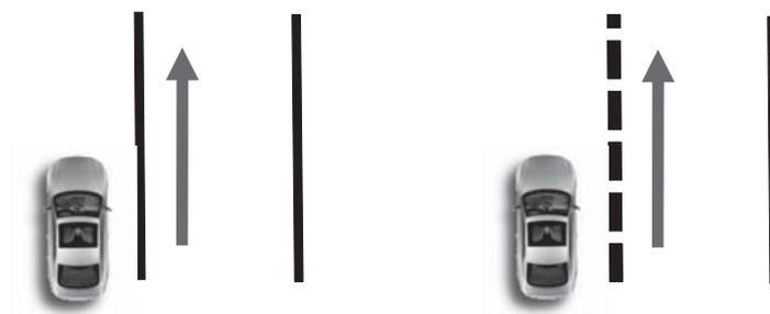
Abbildung 4.19.: Widerlegung der Interpretation der schmalen durchgezogenen und der breiten gestrichelten Linie mit kurzer Lücke von einer Fahrbahngrenze zu einer weiteren Fahrspur in die eigene Fahrtrichtung
