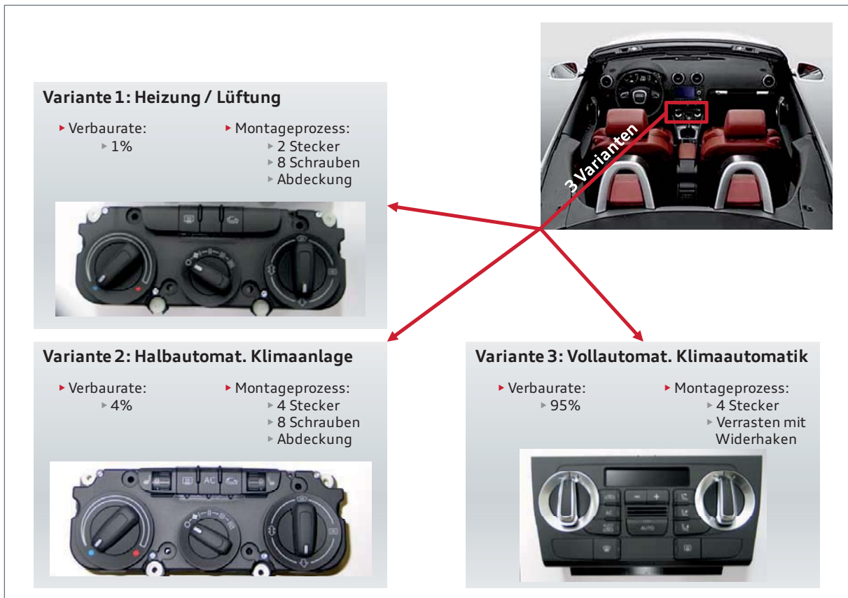
Abbildung 51: Evaluierung der Methode am Beispiel des Klimabedienteils Audi A3 (Quelle: eigene Darstellung)
