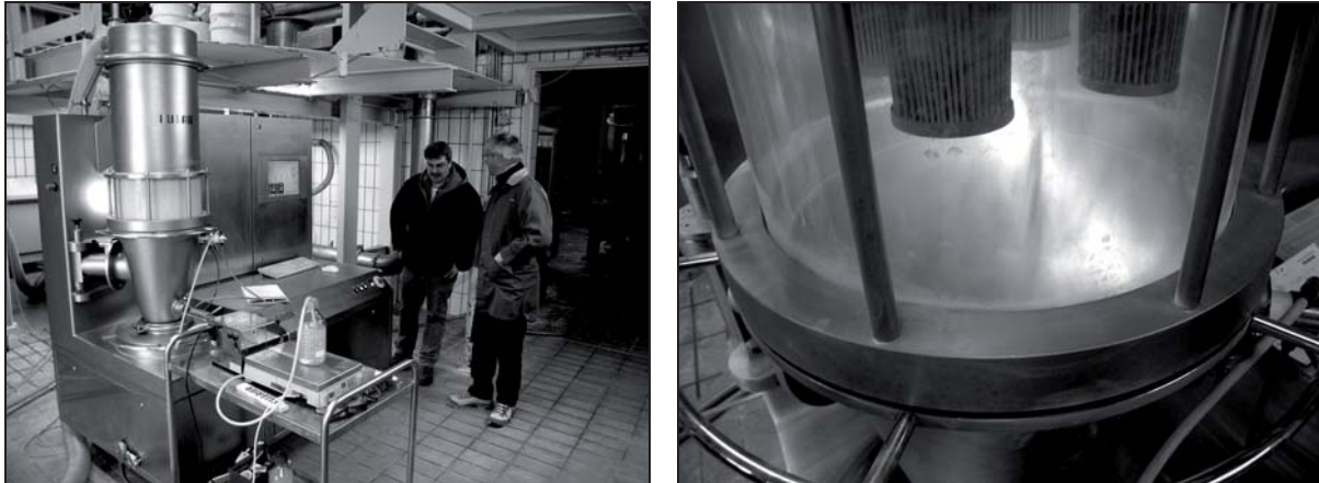
Abb. 49: Granulationsversuche bei der Fa. Allgaier: Wirbelschichttrockner WS-CT 0.2 (links) und Blick in die Wirbelkammer während der Granulation (rechts)
