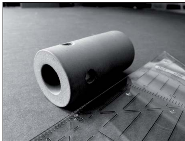
Abb. 47: Erste Musterbauteile aus SN + 20 Gew.-% ABSE nach dem Gasdruck sintern (1800 °C, 1 MPa N 2 -Atmosphäre)
