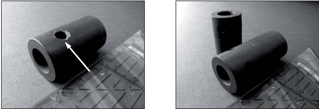
Abb. 46: erste Musterbauteile aus SN + 20 Gew.-% ABSE (pyrolysiert, 1000 °C, N 2 -Atm.): schlechte Bearbeitbarkeit (Kantenausbrüche, siehe Pfeil) bei der Bearbeitung nach dem Pressen (links) und gute spanende Bearbeitbarkeit nach der thermischen Vernetzung (rechts)
