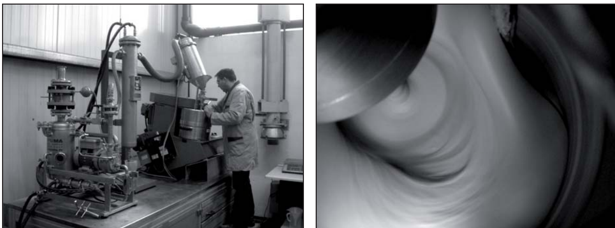
Abb. 48: Granulationsversuche bei der Fa. Eirich: Eirich-Intensivmischer R 02 VAC Ex (links) und Blick in die Mischkammer während der Mischgranulation (rechts)
