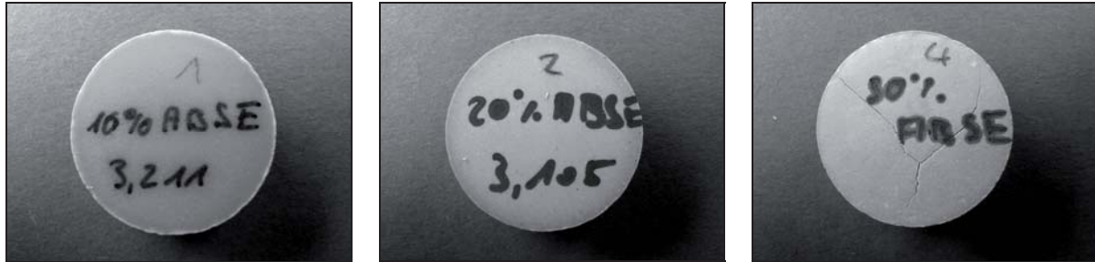
Abb. 38: Proben nach dem Gasdrucksintern (1800 °C, 1 MPa N 2 -Atm.): SN mit 10 (links), 20 (Mitte) bzw. 30 Gew.-% ABSE (rechts); Pressdruck 141 MPa
