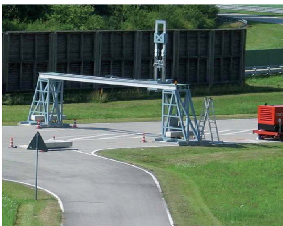
Abbildung 4-18: Aufbau der Fußgängerschutztestanlage [ROTH 2008A]
