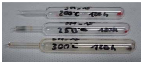
Abbildung 5.7: Quarzglasampullen für Temperaturdauerests der Emittermaterialien.
